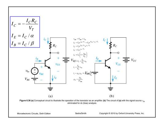
$v_{BE} = V_{BE} + v_{be}$   $i_{C} = I_{S} e^{v_{BE}/V_{T}} = I_{S} e^{(V_{BE} + v_{be})/V_{T}}$   $i_{C} = I_{S} e^{v_{be}/V_{T}}$   $i_{C} = I_{C} e^{v_{be}/V_{T}}$   $i_{C} \approx I_{C} \left(1 + \frac{v_{be}}{V_{T}}\right)$   $i_{C} = I_{C} + \frac{I_{C}}{V_{T}} v_{be}$   $i_{c} = \frac{I_{C}}{V_{T}} v_{be}$   $i_{c} = g_{m} v_{be} \Rightarrow g_{m} = \frac{I_{C}}{V_{T}}$   $g_{m} = \frac{\partial i_{C}}{\partial v_{BE}}$
