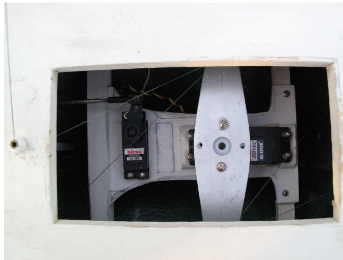
Figure 28: Rigging Setup on Mini 12
